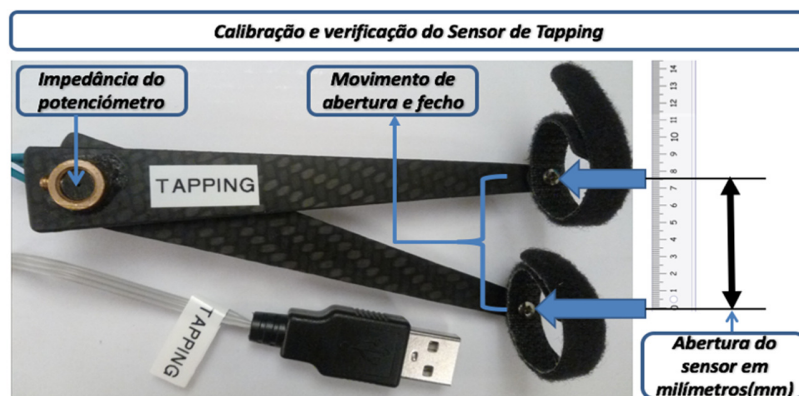
Figura 26 - Calibração e verificação do sensor de Tapping
