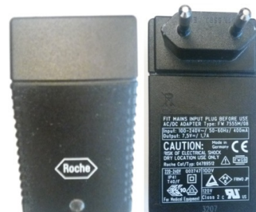
Figura 17 - Transformador de alimentação
